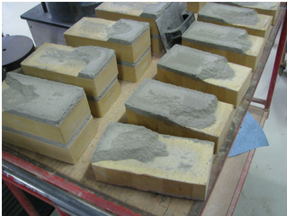
Figur 4. Typiske brudformer ved forskydningsforsøg.
